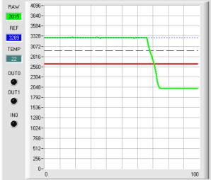
Wenn der aktuelle Messwert RAW (grüne Linie) die Schaltschwelle (rote Linie) unterschreitet, wird der Ausgang OUT0 0V (Fehler). Dies wird über die LED OUT0 visualisiert
